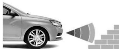
Излучатели установлены слишком высоко.
