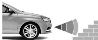
Излучатели установлены слишком высоко.
