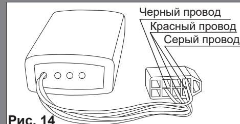
К-Line-адаптер (программатор) GF 911 производства «FERRUM»
