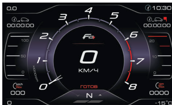
Рис. 17 Информационное поле ЭКП GF949 Слева - скин TECHNO Справа - скин SPORT
